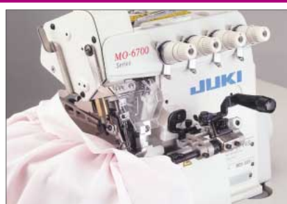
● ひだ取り MO-6714S-BE6-327/S162 (S162: スイング式ひだ取り装置・手動レバー式)
