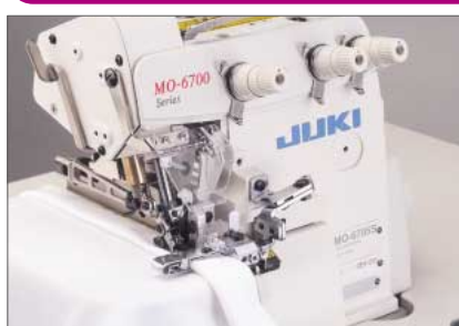
● 裾引き MO-6705S-0E4-41H/L121 (L121: 裾引き定規)
